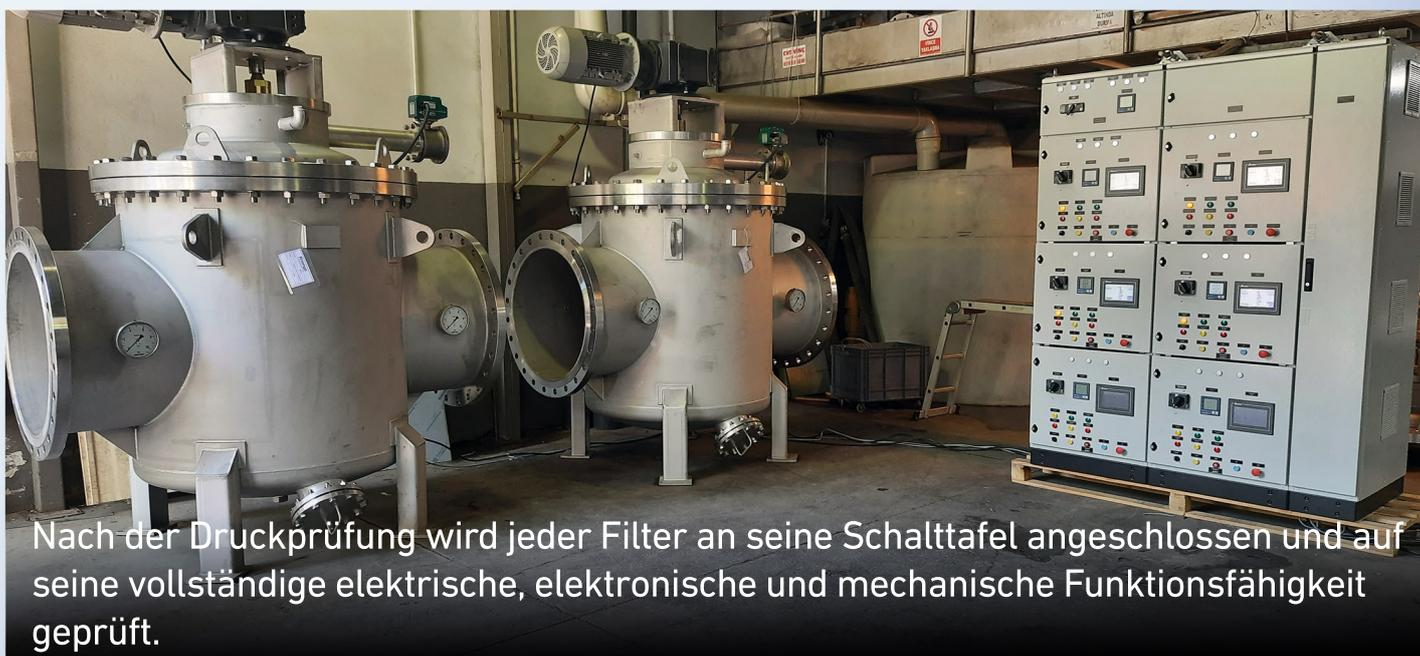
Nach der Druckprüfung wird jeder Filter an seine Schalttafel angeschlossen und auf seine vollständige elektrische, elektronische und mechanische Funktionsfähigkeit geprüft.
