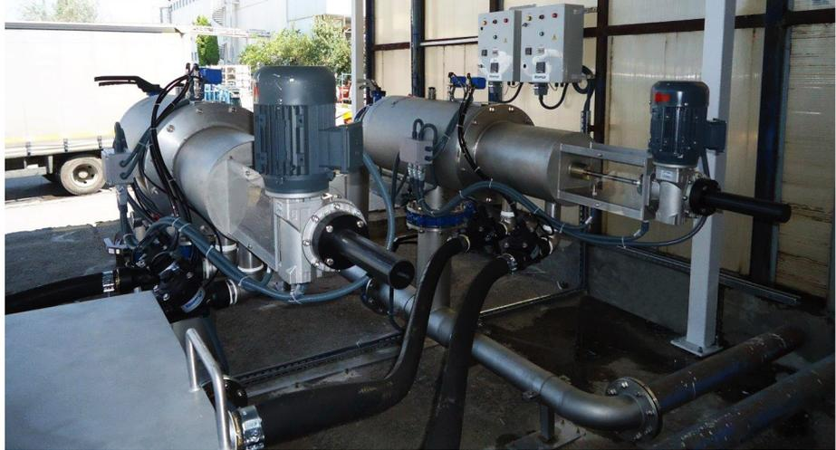
El modelo de filtro Filternox® SPT-WBV-MR, de tecnología patentada, permite la filtración de agua que contiene partículas finas y gruesas. El modelo SPT-WBV-MR posee un sistema limpiador de doble efecto con cepillos y boquillas de succión. La limpieza automática de las partículas gruesas en la superficie de la malla se realiza mediante cepillos y el de las finas a través de boquillas de succión.
