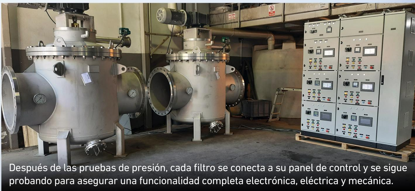
Después de las pruebas de presión, cada filtro se conecta a su panel de control y se sigue probando para asegurar una funcionalidad completa electrónica, eléctrica y mecánica.
