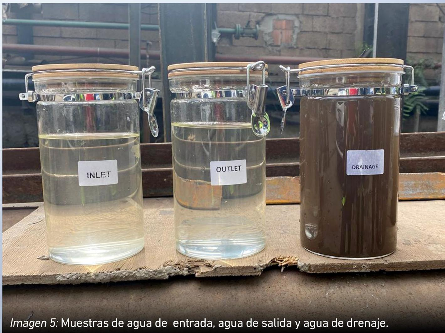
Imagen 5: Muestras de agua de entrada, agua de salida y agua de drenaje.
