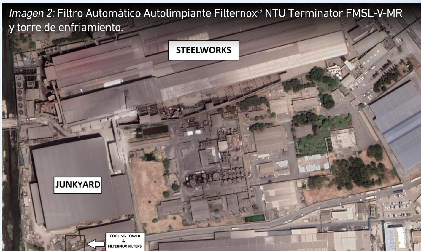
La torre de enfriamiento está ubicada cerca de las acerías de la planta y del depósito de chatarra. Por lo tanto, el agua de refrigeración se contamina con partículas de hierro y polvo. (Imagen 2)
